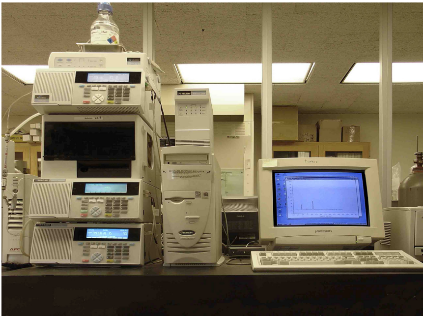
Fig. 2: HPLC usado na determinação de ativos de fungicidas no couro
